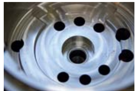
Die Werkstücke, die bei Braun in der Elba gereinigt werden, weisen mittlere Verschmutzungen in Form von Ölen, Emulsion und Spänen auf
